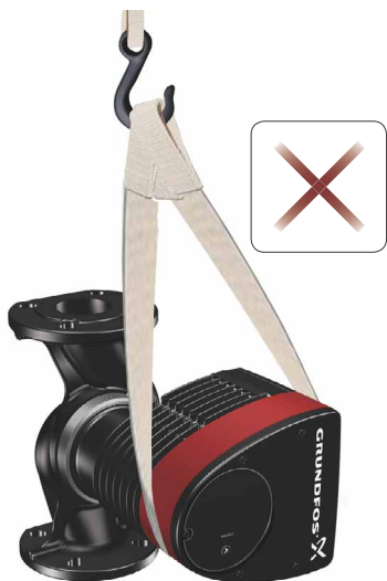
Rys. 6 Nieprawidłowe podnoszenie pompy
